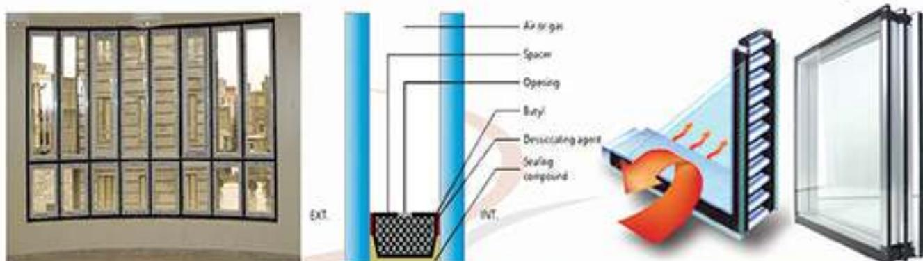
در شیشه دوجداره غالباً از اسپیسرهای آلومینیوم استفاده می شود که درون اسپیسر را با ماده رطوبت گیر پر می کنند، این ماده سبب جذب رطوبت هوای مابین شیشه ها می گردد و توسط مواد درزگیر مناسب، کاملاً آب بندی شده است. اسپیسر های مورد استفاده در شیشه دوجداره در ضخامت های مختلف ۱۴, ۱۶, ۲۰, ۲۴, ۳۰ میلی متر موجود می باشد. در ترتیبه شیشه های دوجداره، بسته به نیاز و سلیقه می توان از انواع شیشه های معمولی، رنگی، رفلکس، ملینت و سکوریت استفاده کرد.
